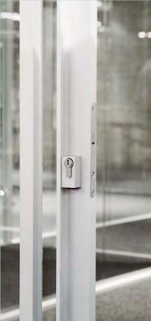
La puerta corredera, con hoja acristalada y vidrio templado transparente de 10 mm, tiene un perfil de ajuste que también sirve de tirador. La hoja se desliza centrada respecto al perfil, lo que permite utilizarla con vidrio doble o con vidrio simple offset. La cerradura con cilindro de perfil europeo y el sistema de cierre de puerta con tope ralentizado son opcionales.
