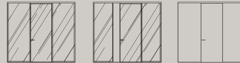
Porta a battente, altezza massima 300 cm / Hinged door, maximum height 300 cm / Drehtür, max. Höhe 300 cm / Porte battante, hauteur maximale 300 cm / Puerta batiente, altura máxima 300 cm
