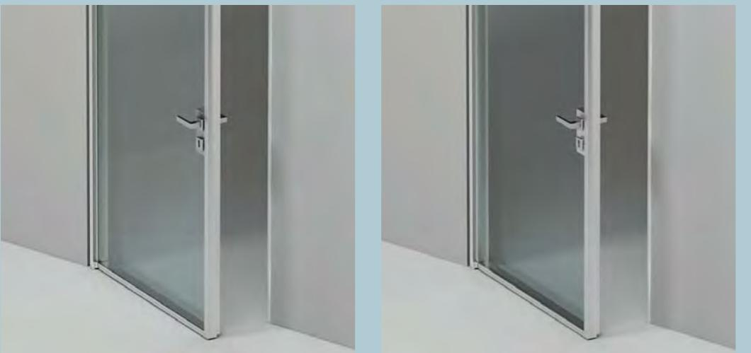
Die Türen sind mit Einfachverglasung mit polierter Kante, mit versetzter Einfachverglasung, mit Doppelverglasung und als Volltüren erhältlich. Die Einfachverglasung besteht aus 10 oder 12 mm starkem, thermisch vorgespanntem Klarglas. Die Doppelverglasung besteht aus 10 mm und 6 mm thermisch vorgespanntem Glas. Die Volltür besteht aus zwei 18 mm starken melaminharzbeschichteten Spanplatten.
