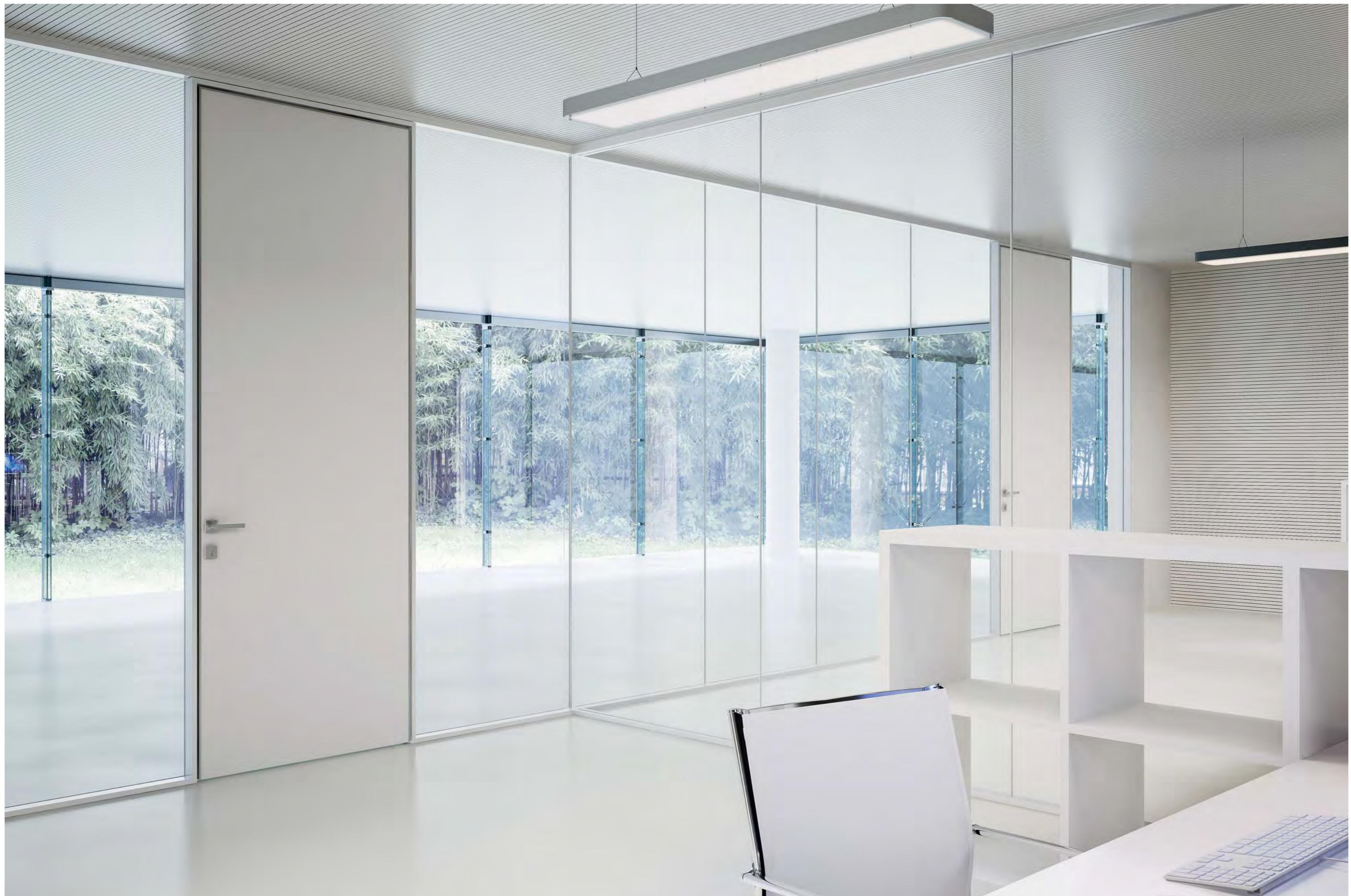
**La gamma comprende pareti doppio vetro, singolo offset e singolo centrale. La stabilità e la tenuta acustica sono garantite da guarnizioni in PVC e da una speciale guarnizione in pivilene. La sezione dei profili in alluminio varia da 69x20 mm a 78x47 mm. I vetri sono stratificati (5+5 o 6+6 mm) con interposta pellicola di PVB, oppure possono essere utilizzati vetri stratificati di 6+6 mm con interposta una pellicola di PVB antirumore.**
