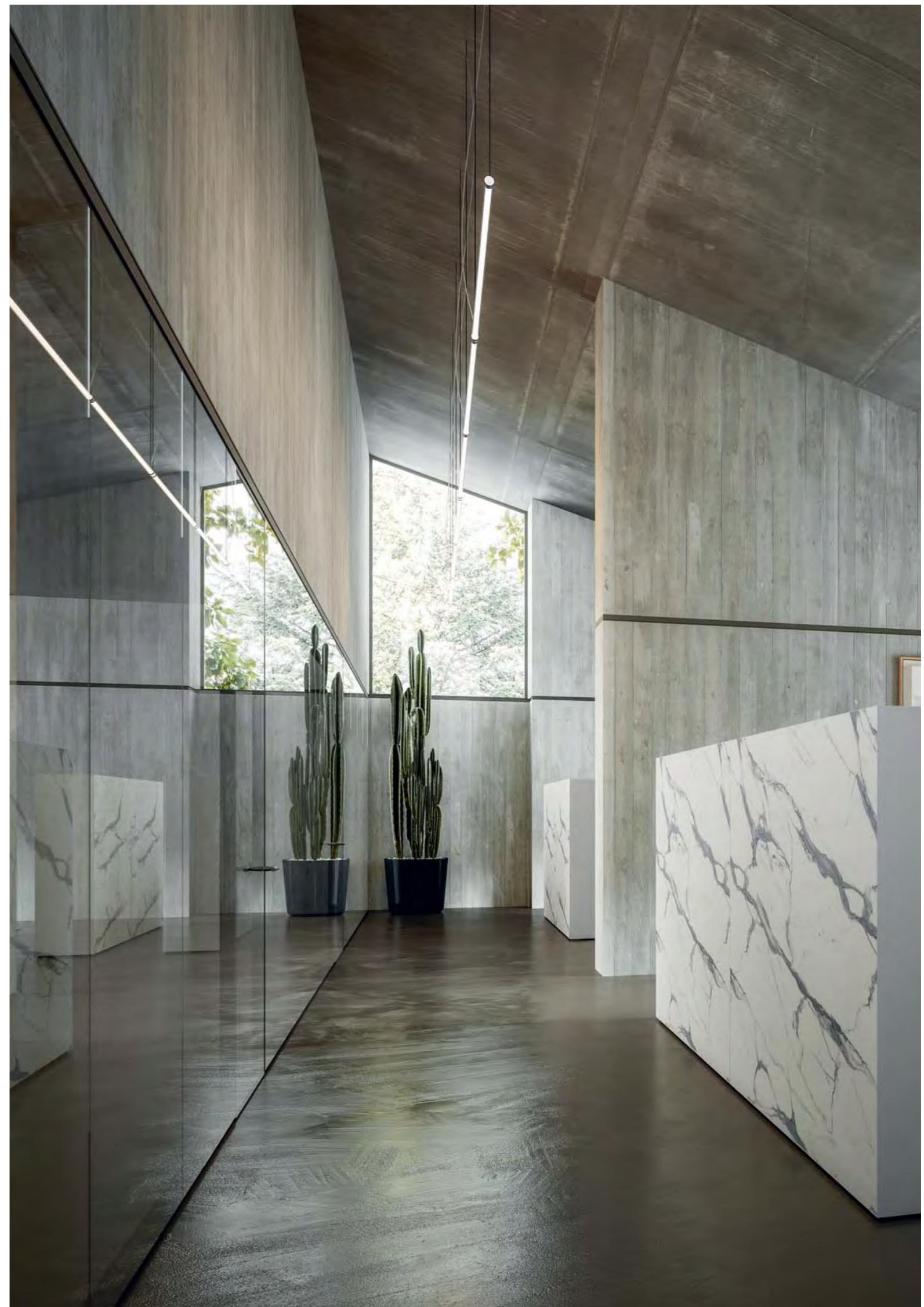
**La parete cieca è realizzata con pannellature in truciolare nobilitato spessore 18 mm, sagomati per adattarsi alla struttura in alluminio.**
