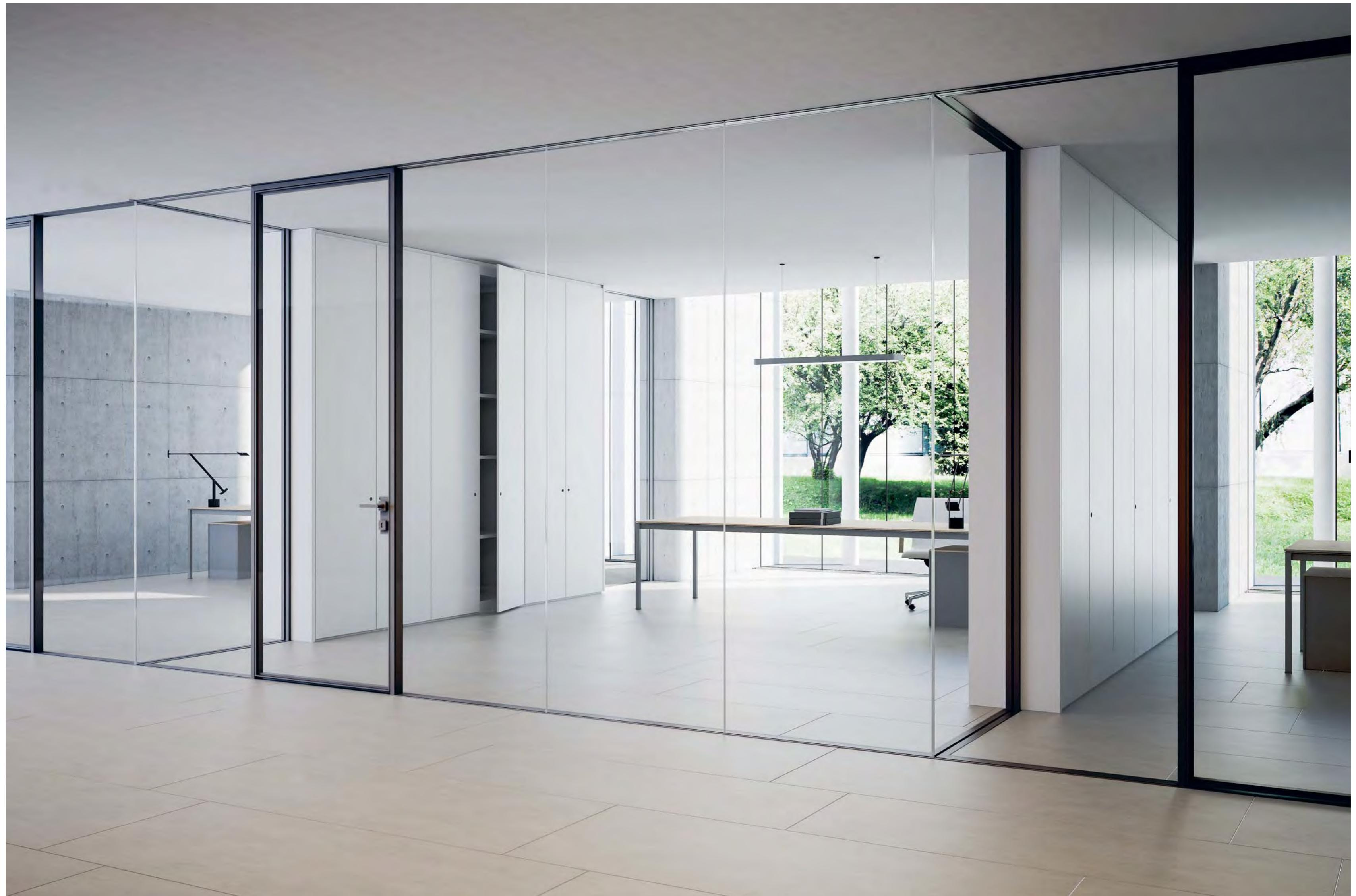
**La versione ad incasso presenta una struttura integrata nel pavimento o nel controsoffitto. L'incasso inferiore presenta una sezione di 88x20 mm. Il profilo superiore può essere incassato su un lato oppure su entrambi.**
