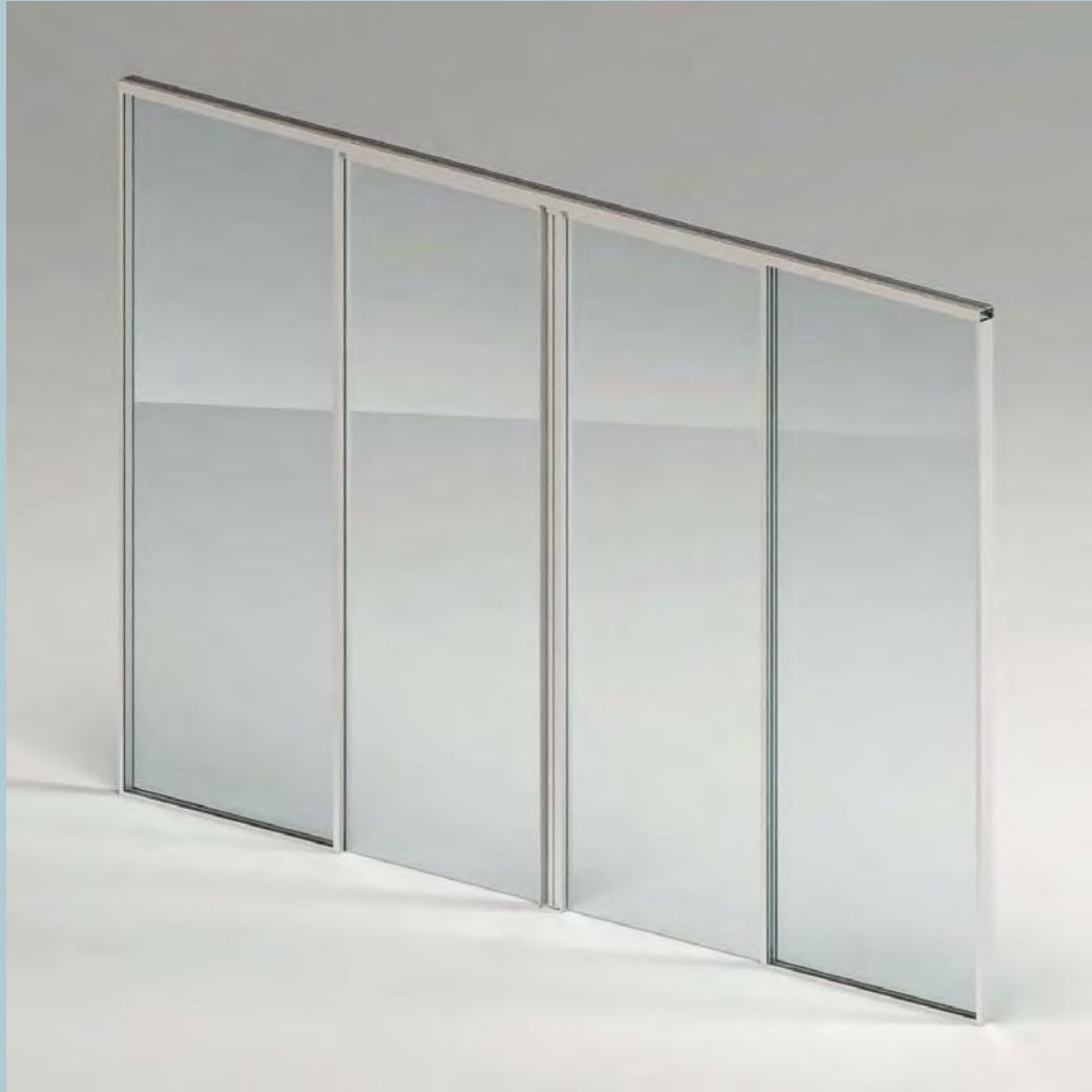
Die Glasschiebetür mit 10 mm starkem, thermisch vorgespanntem Klarglas ist mit einem Falzprofil ausgestattet, das gleichzeitig als Griff dient. Der Flügel lässt sich mittig im Profil verschieben, so dass die Tür sowohl mit Doppel- als auch mit versetzter Einfachverglasung ausgestattet werden kann. Schloss mit Euro-Profilzylinder und Türschließer für ein sanftes Schließen der Tür sind optional erhältlich.
