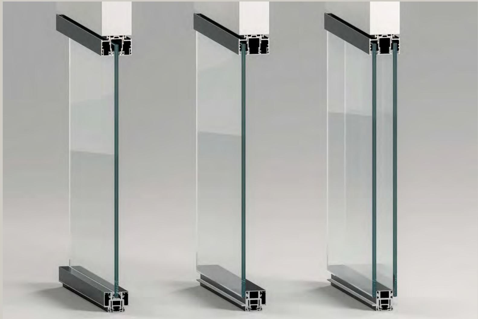
Das Sortiment umfasst doppelverglaste Trennwände, einfachverglaste versetzte Trennwände und einfachverglaste Trennwände. PVC-Dichtungen und eine spezielle Dichtung aus mikrozellulärem PVC-Schaum sorgen für Stabilität und Schalldämmung. Die untere Schiene ist um +/- 7 mm teleskopierbar.
