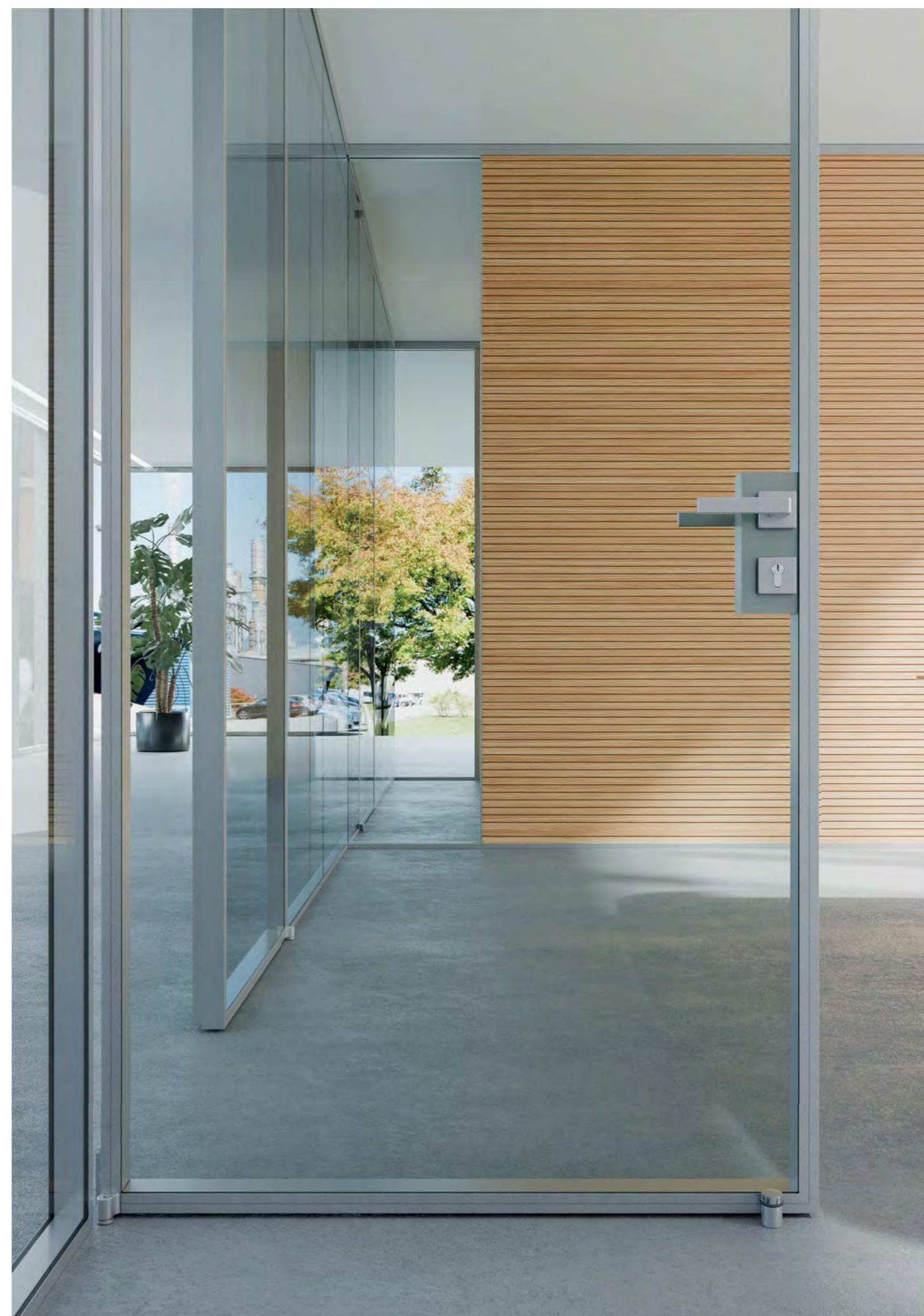
**La porta scorrevole ad anta vetrata, con vetro temperato trasparente da 10 mm, presenta un profilo di battuta che funge anche da maniglione. L'anta scorre centralmente rispetto al profilo, permettendone l'utilizzo sia con doppio vetro che con vetro singolo offset. Serratura con cilindro a profilo europeo e sistema di chiusura porta con arresto rallentato sono opzionali.**
