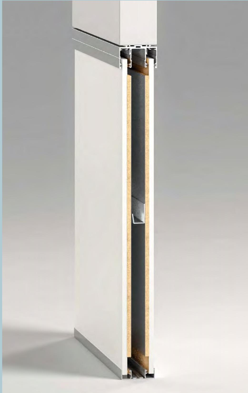
Passend zur Aluminiumkonstruktion besteht die Vollwand aus 18 mm starken melaminharzbeschichteten Spanplatten. Der Plattenzwischenraum kann mit einer schalldämmenden Matte ausgefüllt werden. Der Aufbau entspricht der verglasten Ausführung. Aluminiumprofile und Dichtungen tragen zur Schalldämmung und Stabilität bei.
