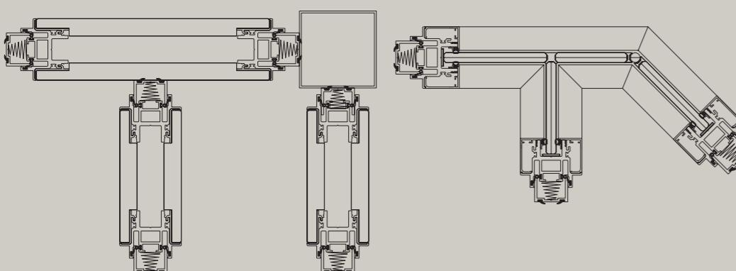
Das System bietet verschiedene Möglichkeiten für die Ausführung von Glasecken mit transparenten Polycarbonatprofilen. Der Eckanschluss an die Vollwand kann mit Paneelen oder Aluminiumrohren ausgeführt werden.
