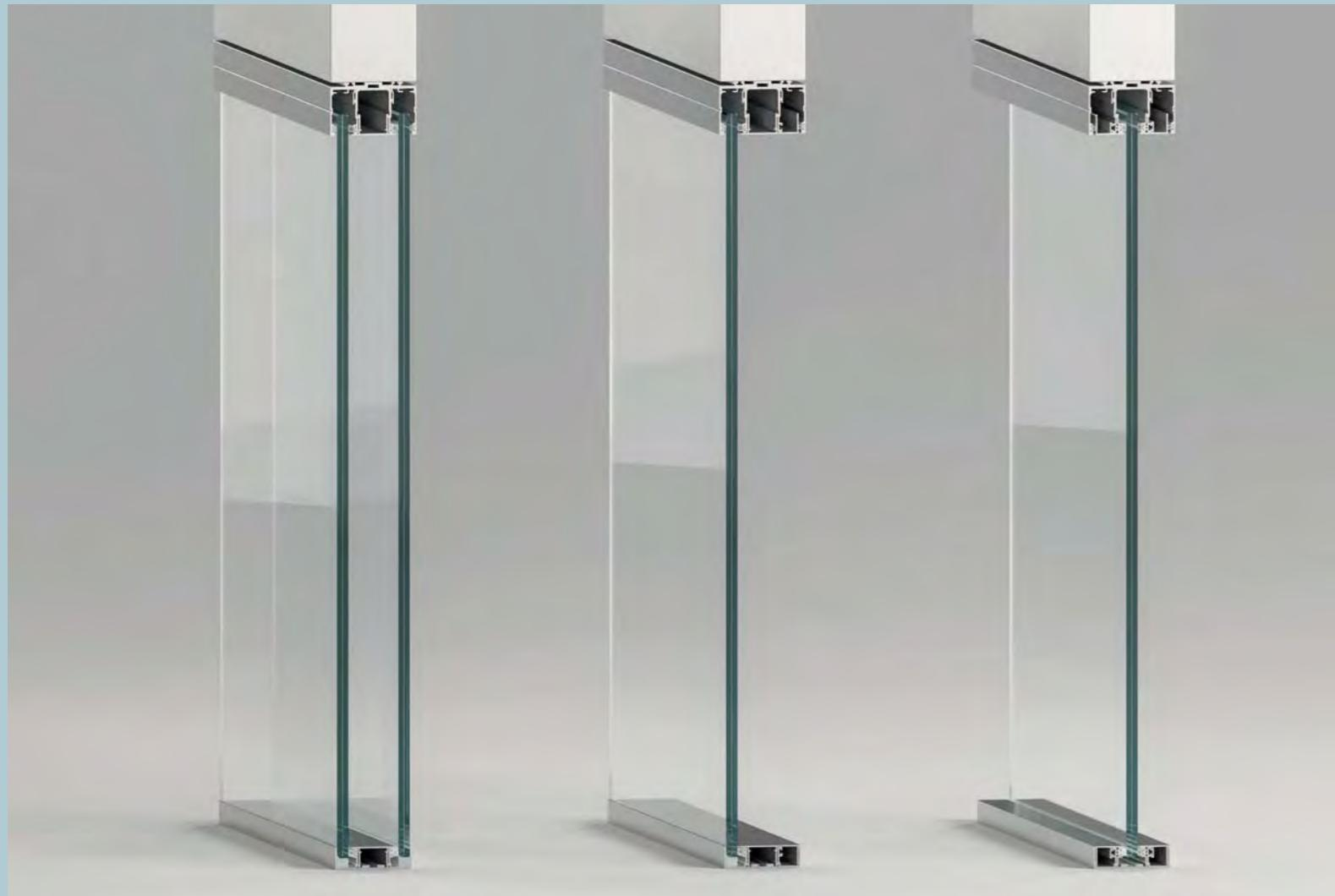
Das Sortiment umfasst doppelverglaste Trennwände, einfachverglaste versetzte Trennwände und einfachverglaste Trennwände. PVC-Dichtungen und eine spezielle Dichtung aus mikrozellulärem PVC-Schaum sorgen für Stabilität und Schalldämmung. Die Aluminiumprofile haben Querschnitte zwischen 69x20 mm und 78x47 mm. Die Verglasung besteht entweder aus Verbundglas (5+5 oder 6+6 mm) mit PVB-Folie dazwischen oder aus Verbundglas 6+6 mm mit schalldämmender PVB-Folie dazwischen.
