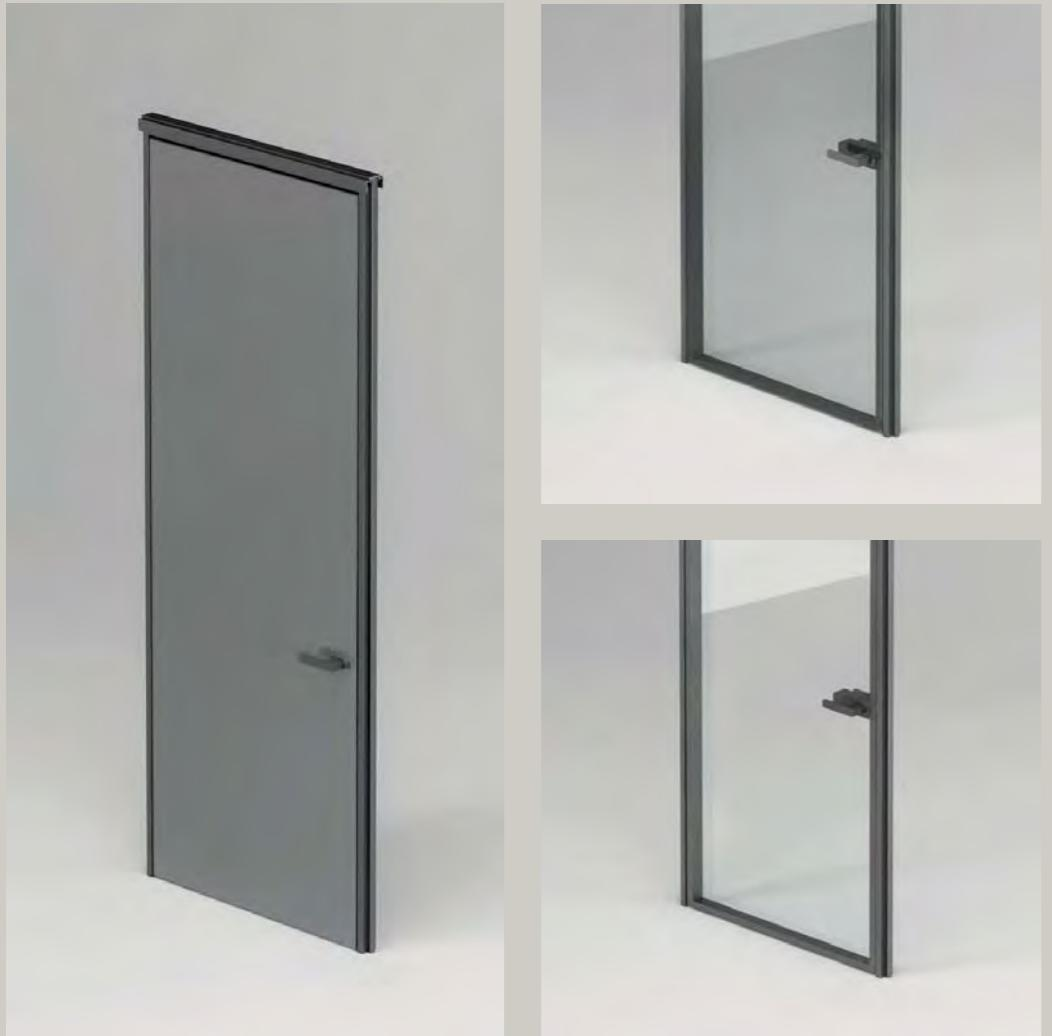
Die Türen sind mit versetzter Einfachverglasung, mit Doppelverglasung und als Volltüren erhältlich. Die akustischen Dichtungen sind aus weichem Formsilikon gefertigt. Das Standardtürmodul kann als Schiebe- oder Drehtür ausgeführt werden. Die Durchgangsbreite beträgt über 90 cm.
