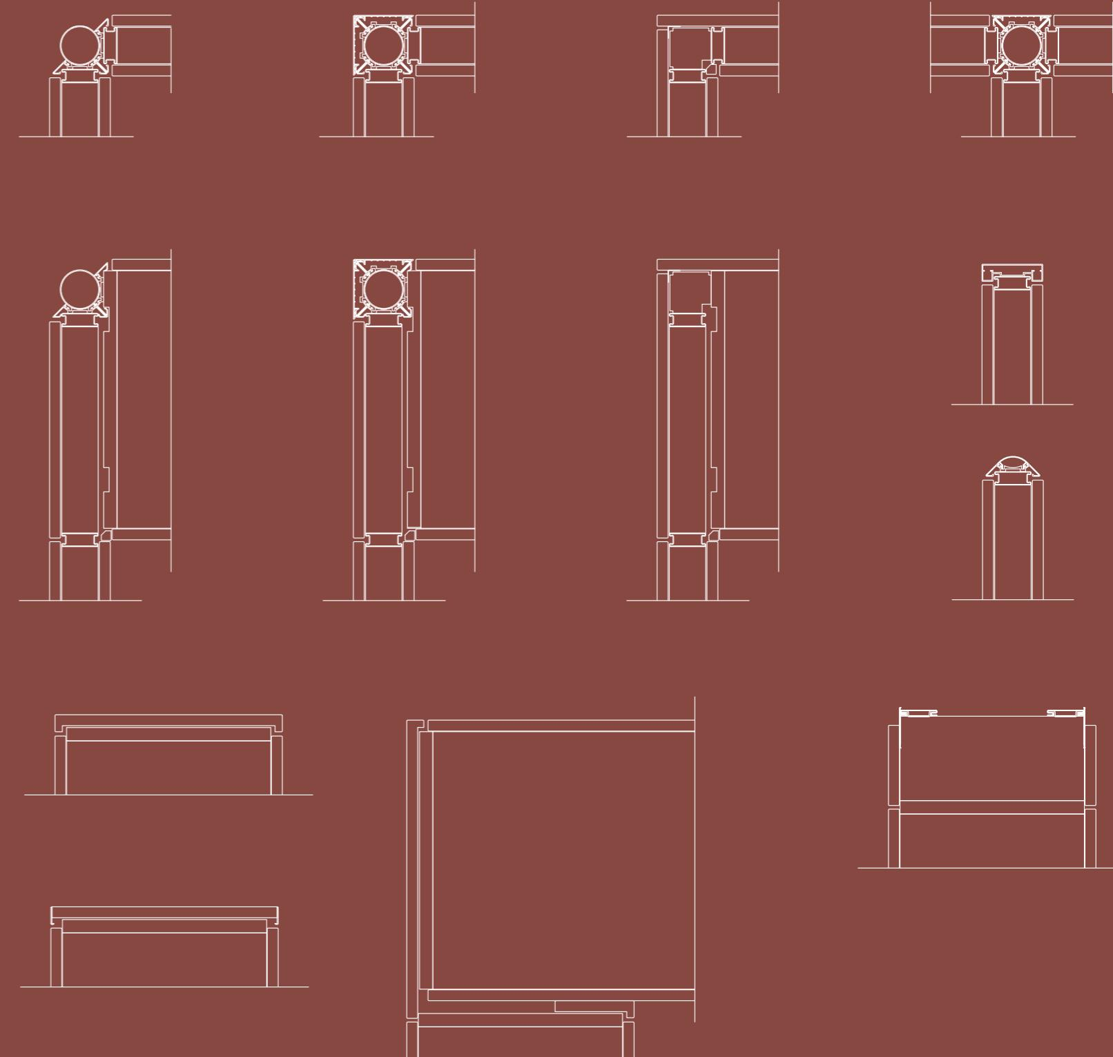
Für den Eckanschluss an das Wandsystem bietet TM eine große Auswahl an runden und eckigen Aluminiumprofilen oder Paneelen.
