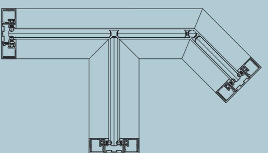
Das System bietet verschiedene Möglichkeiten für Glasecken mit transparenten Polycarbonatprofilen. Die Vollwände können verkleidet oder mit Aluminiumprofilen ausgeführt werden.
