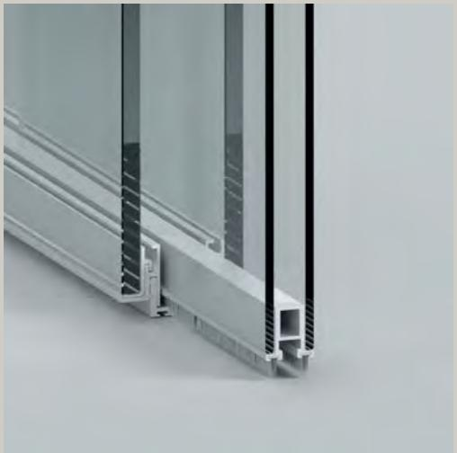
Die Glasschiebetür besteht aus zwei 4 mm starken, thermisch vorgespannten Glasscheiben mit polierter Kante und 1 mm Fase. Sie umschließen einen stranggepressten Aluminiumrahmen mit einem Querschnitt von 20x25 mm. Die Glaswand gleitet auf teflonbeschichteten Druckgussbahnen zur optimalen Schalldämmung und ist mit einer Doppelbremse ausgestattet.
