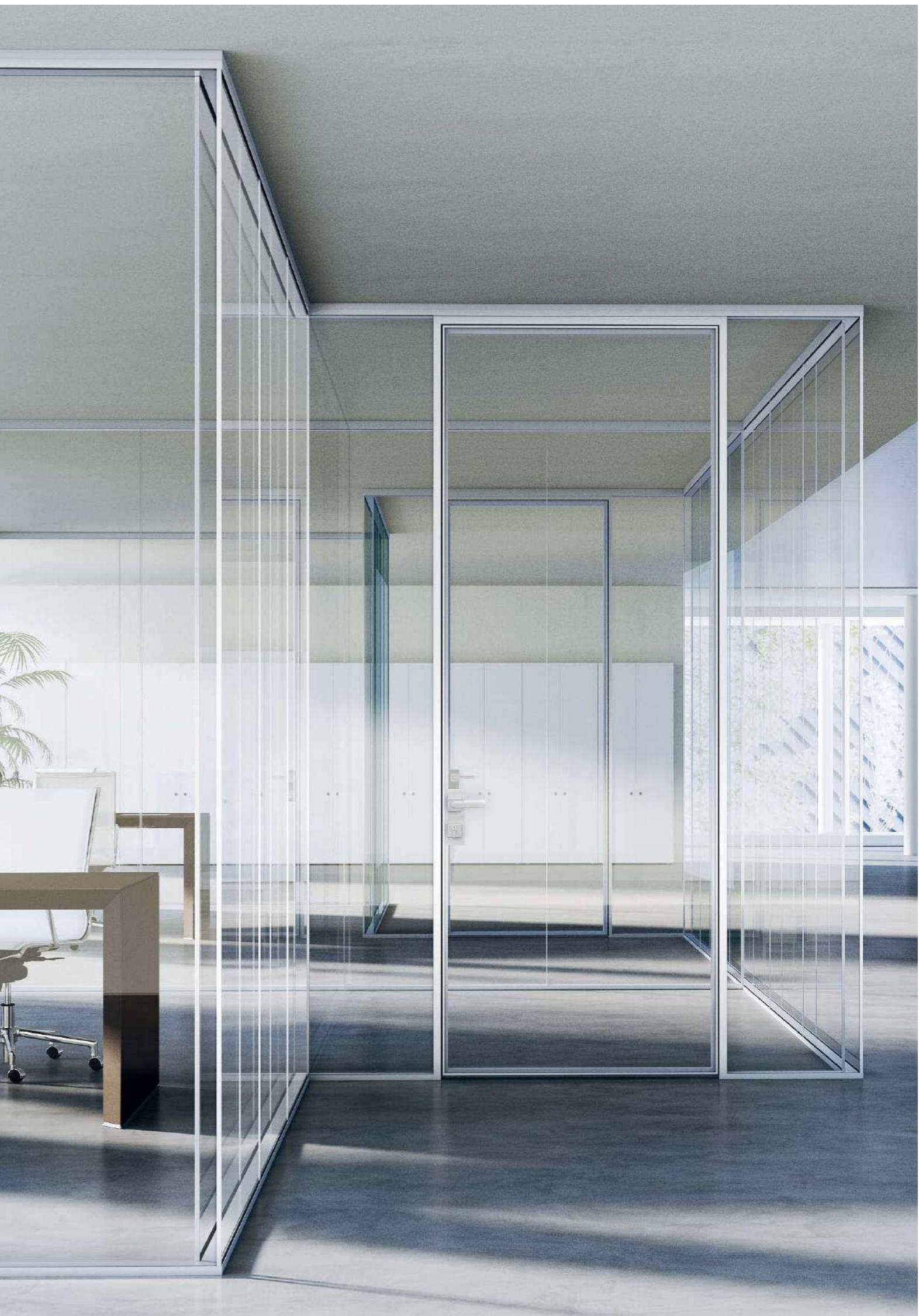
**La parete cieca è realizzata con pannellature in truciolare nobilitato spessore 18 mm, sagomati per adattarsi alla struttura in alluminio. L'intercapedine tra i pannelli può essere riempita con materassino fonoisolante. La struttura richiama quella della versione vetrata, con profili in alluminio e guarnizioni che contribuiscono all'abbattimento acustico e alla stabilità.**
