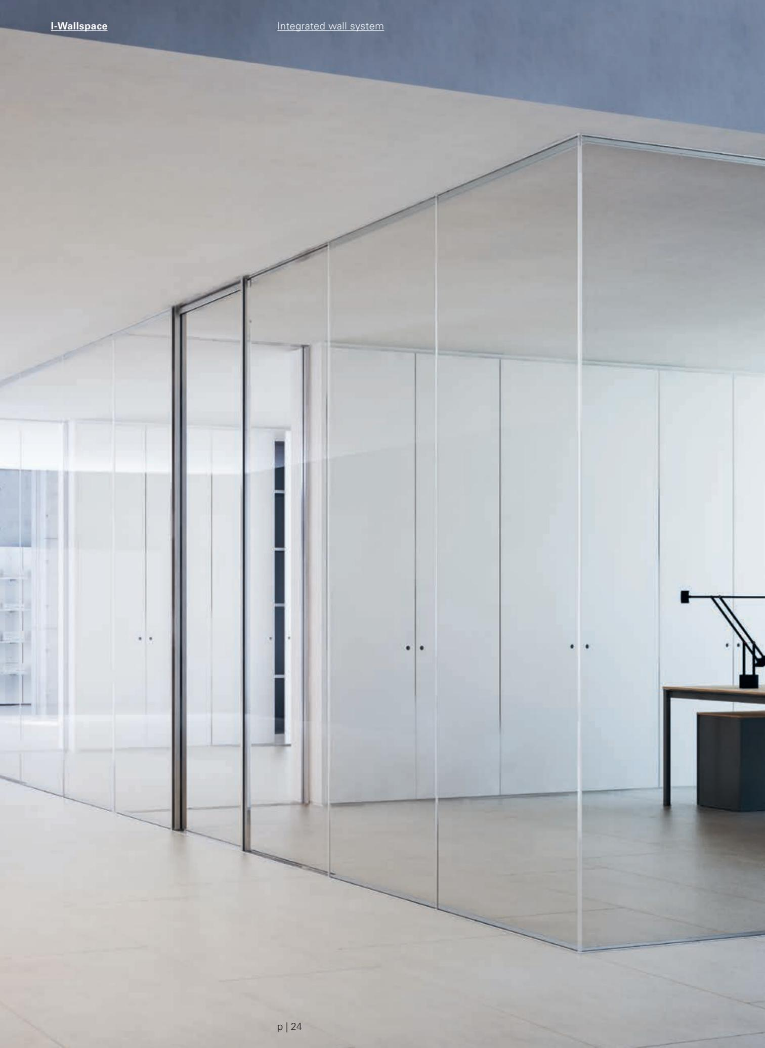
**Porta scorrevole.** Realizzata in cristallo trasparente molato a filo lucido spessore 10mm, il profilo di battuta ha funzione di maniglione. La porta scorre centralmente rispetto al profilo parete ed è utilizzabile nelle pareti vetro doppio o vetro singolo offset. Serratura con cilindro a profilo europeo e sistema di arresto rallentato opzionali.
