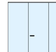
Porta a battente vetrata, altezza massima 300 cm / Hinged glass door, maximum height 300 cm / Glastür, max. Höhe 300 cm / Porte battente vitrée, hauteur maximale 300 cm / Puerta batiente acristalada, altura máxima 300 cm
