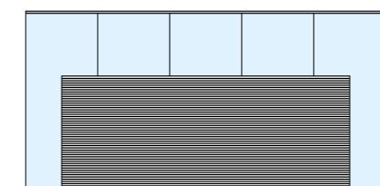
Parete vetro singolo centrale con inserto fonoassorbente 4akustik a doghe / Central single-glazed partition with 4akustik sound-absorbent slatted insert / Wand mit zentraler Einfachverglasung und schallabsorbierendem Einsatz aus Lamellen 4akustik / Cloison simple vitrage centré avec insert insonorisant 4akustik à lattes / Pared de vidrio simple central o aplicación insonorizada 4akustik de duras
