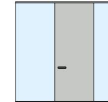
Porta a battente con pannello fresato, altezza massima 300 cm / Hinged door with milled panel, maximum height 300 cm / Fliegeltür mit gefräster Platte, max. Höhe 300 cm / Porte battante avec panneau rainuré, hauteur maximale 300 cm / Puerta batiente con panel fresado, altura máxima 300 cm
