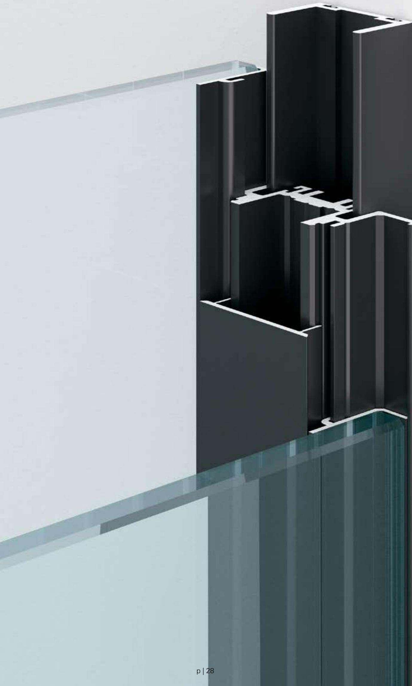
**Profilo a muro.** La partenza da muro è disponibile sia nella versione a vista – che permette un livellamento verticale di circa 15 mm per compensare eventuali irregolarità delle pareti dell'edificio – sia nella versione da incasso, integrata in pareti o rivestimenti.
